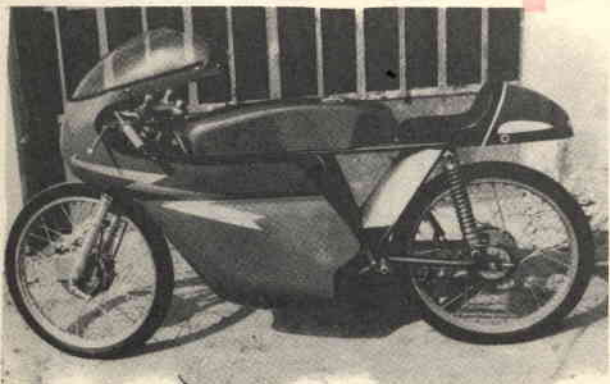
Foto 6. - Il nostro prototipo ultimato. Si notino la solidità e la pulizia di linee dell'insieme, proprie delle macchine di gran classe. Serbatoio e sella sono profilatissimi e sono realizzati in fibra di vetro.
